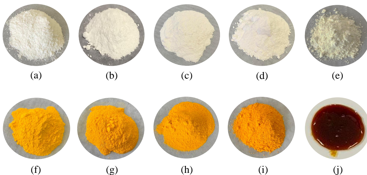
รูปที่ 4.4 ผงสีของ (a) ZnAl-LDH, (b) cZnAl-LDH300, (c) cZnAl-LDH500, (d) cZnAl-LDH700, (e) ZnO, (f) Phlai@ZnAl-LDH, (g) Phlai@cZnAl-LDH300, (h) Phlai@cZnAl-LDH500, (i) Phlai@cZnAl-LDH700 และ (j) Phlai extract
